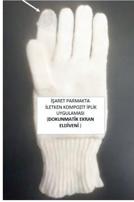
İşaret parmakta iletken kompozit iplik uygulaması (dokunmatik ekran eldiveni)
